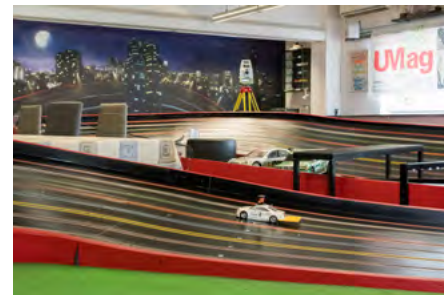
Abb. 1: Tracking eines Slotracing-Rennwagens mit einer Leica Multistation MS60 (Wolf, 2020).
