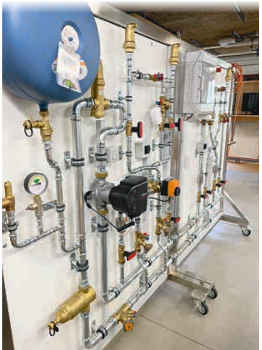
durchführen und dann die Pumpe auf den optimalen Betriebspunkt einstellen. Parallel dazu wird diese Prozedere mit Kombiventilen durchgeführt, wobei die Studierenden die Vorzüge von Kombiventilen unmittelbar erleben bzw. verstehen können.
